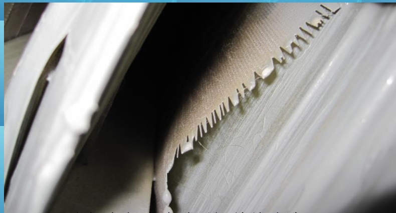
雷电冲击试验时匝间绝缘击穿
