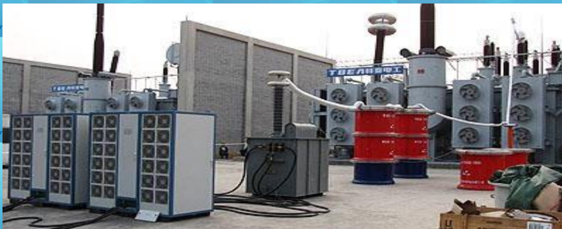
500kV 分级绝缘变压器感应耐压现场试验
