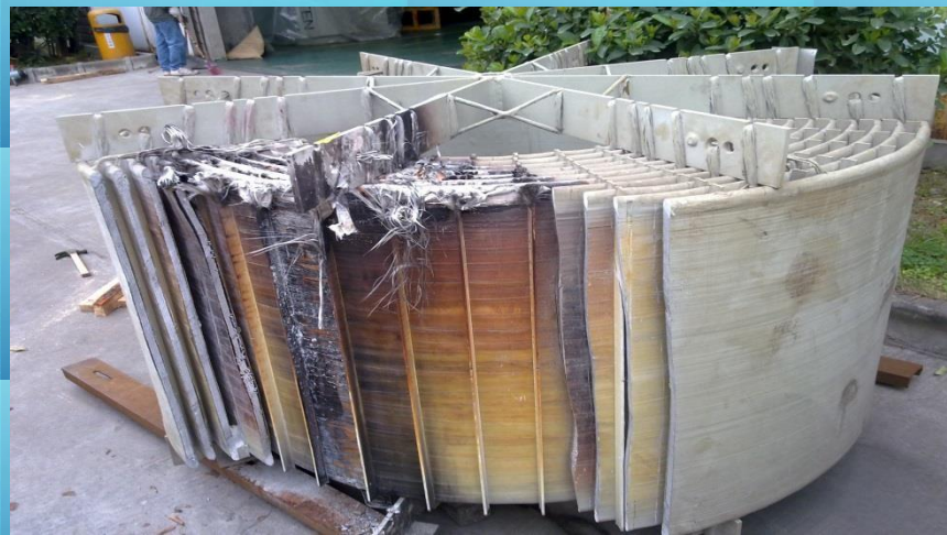
干式空心电抗器绕组匝间短路故障情况
