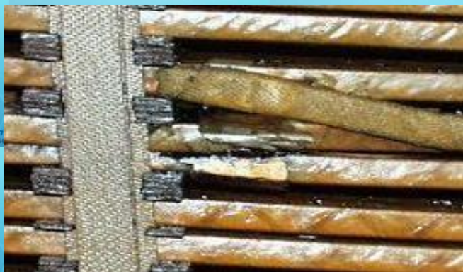
变压器匝间绝缘损坏放电痕迹
