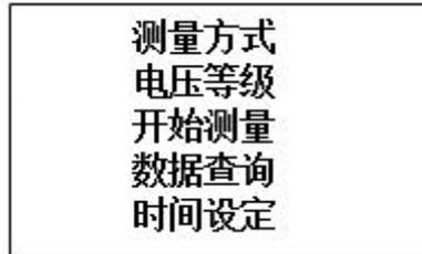
选择测量方式:测电容时可选单相电容、三相△、三相 Y，三相 Yn，三相 III，测电抗器电感时可选择大电感、小电感方式，小于 4mH 时只能选择小电感方式。**注意:选错可能损坏仪器!**
