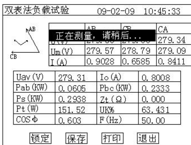
图 12 负载损耗正在测量计算页面
